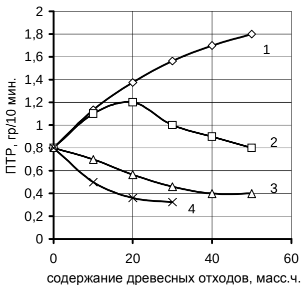
Рис. 2. Зависимость показателя текучести расплавов пластифицированного ПВХ от содержания древесных отходов 1- лигнин; 2 - древесная мука; 3 - пробковая крошка; 4 - СКОП
