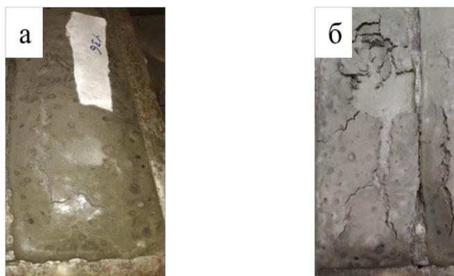
Рис. 6. Вид образцов бетона, содержащих ГФ «ФЭС-50» более 0,25%
