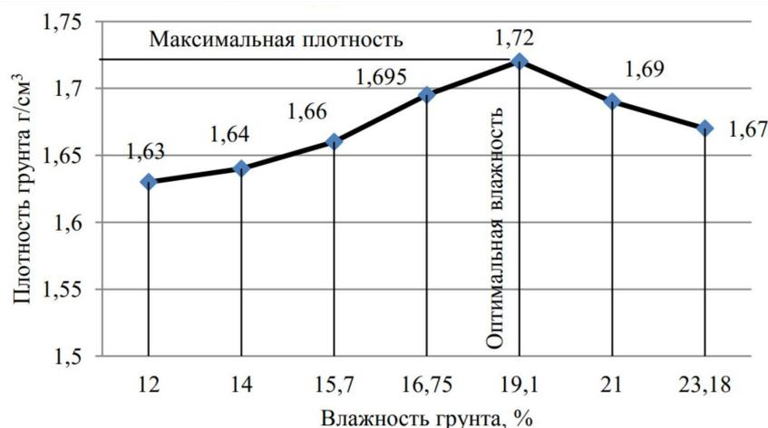
Рис. 1. График зависимости максимальной плотности грунта от оптимальной влажности (иллюстрация авторов)
