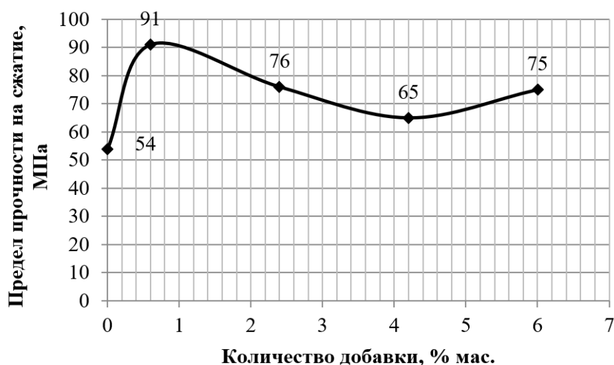
Рис. 5. Изменение предела прочности цементного камня в зависимости от количества добавки волластонита активированного механоакустическим методом (иллюстрация авторов)
