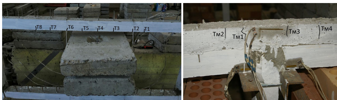
Рис. 3. Образование трещин в балках: а – схема на 1-м этапе; б – схема на 2-м этапе; в – фото (сборная часть на 1-м этапе); г – фото (монолитная часть на 2-м этапе) (иллюстрация авторов)
