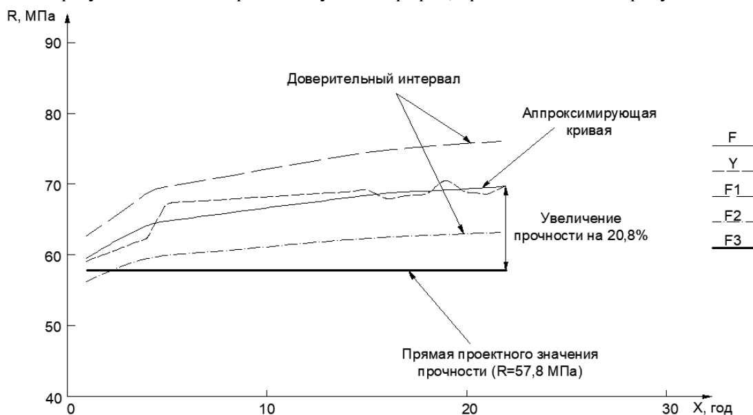
Рис. 3. - График изменения прочности блоков тоннелей Казанского метрополитена (иллюстрация авторов)
