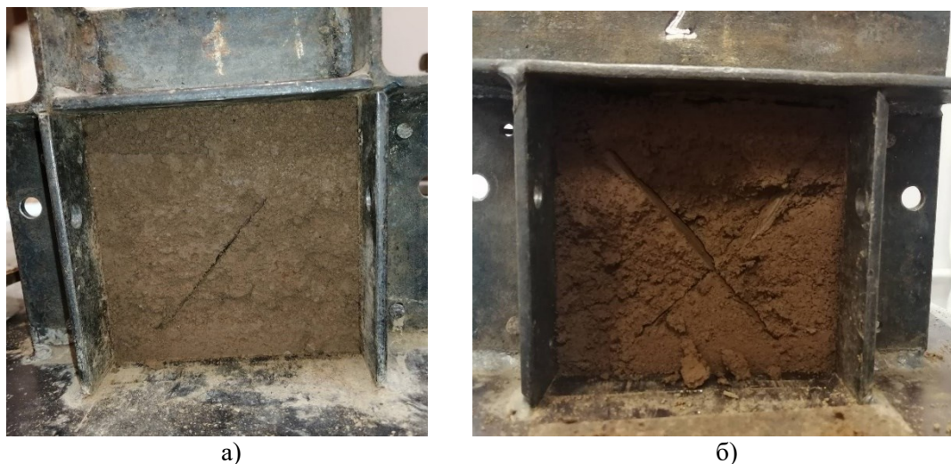
Рис. 1. Образцы с трещинами в плоскостях равновесия: а) с одной трещиной; б) с двумя пересекающимися трещинами в двух плоскостях равновесия (иллюстрации авторов)
