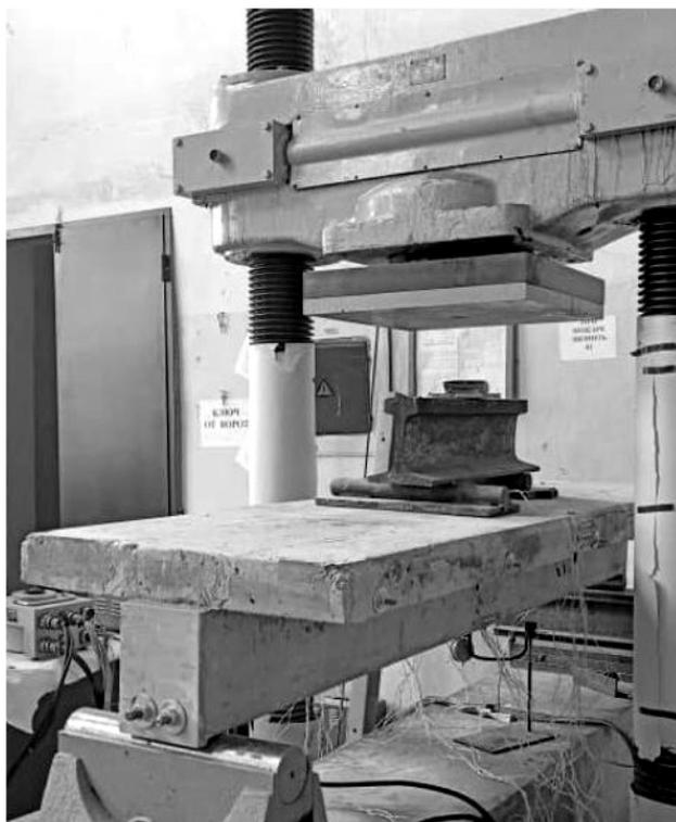
Рис. 2. Испытания опытной балки с помощью прессы ИПС-200 (иллюстрация авторов)
