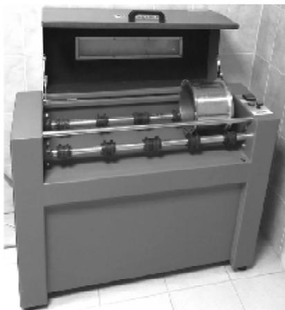
Рис. 2. Установка Микро-Деваль ТА-0620 (иллюстрация автора)
