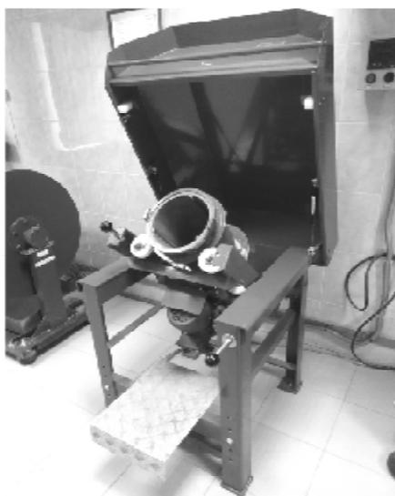
Рис. 3. Испытательная установка КМ-1 для испытания Nordic test (иллюстрация авторов)
