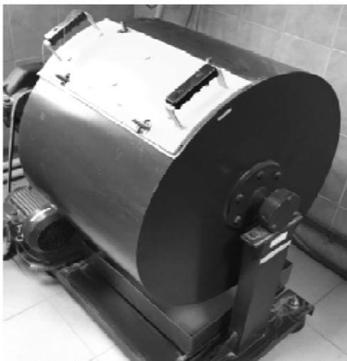
Рис. 1. Полочный барабан (иллюстрация авторов)
