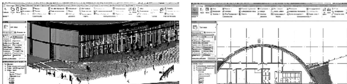
Рис. 6. Трехмерное и двухмерное отображение облака точек [10]
