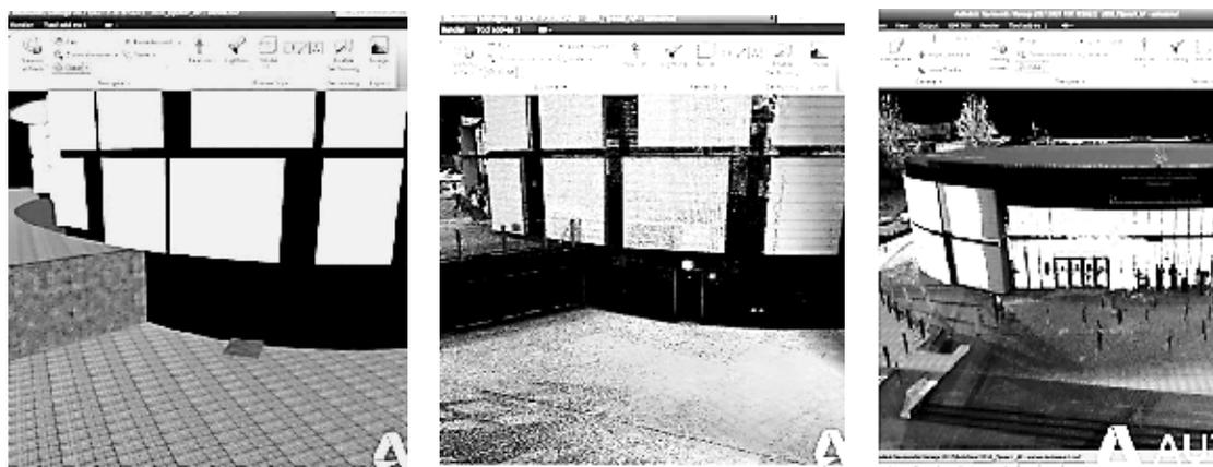
Рис. 5. Совмещение облака точек с проектной моделью [10]
