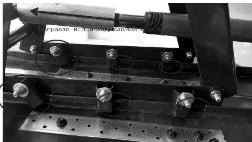
Рис. 9. Проведение испытаний снегозадержателя крыши (проскальзывание креплений, разворот крайнего крепления) (иллюстрация авторов)
