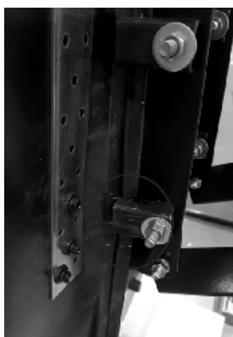
Рис. 6. Проведение испытаний ограждения крыши (деформации фальцев) (иллюстрация авторов)
