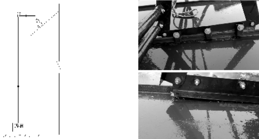
Рис. 2. Схема проведения натурных испытаний, деформации крепления (иллюстрация авторов)
