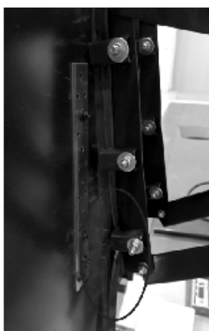
Рис. 7. Проведение испытаний ограждения крыши (деформации фальцев) (иллюстрация авторов)
