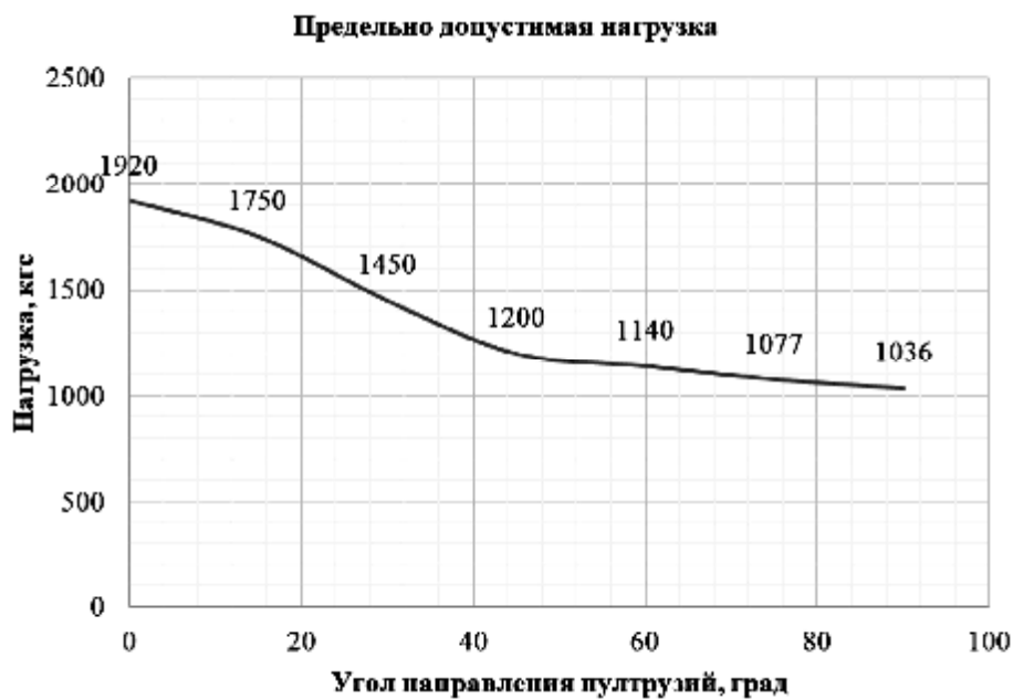
Рис. 7. График зависимости несущей способности при смятии от угла направления пултрузии (иллюстрация авторов)
