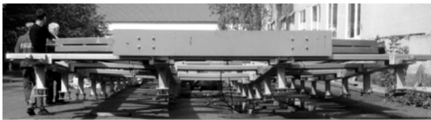
Рис. 6. Внезапное вертикальное перемещение из плоскости крайних узлов ферм и элементов стенда (ЗАО «Ариада, 2018 г.)
