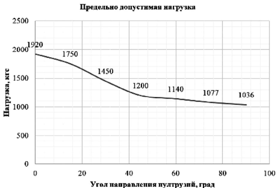
Рис. 7. График зависимости несущей способности при смятии от угла направления пултрузии (иллюстрация авторов)
