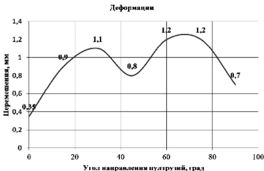
Рис. 8. График зависимости перемещений от угла направления пултрузии (иллюстрация авторов)
