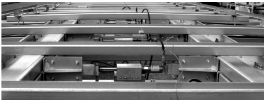
Рис. 4. Установка элементов, обеспечивающих устойчивость верхних поясов из плоскости и гидродомкратов, создающих нагрузку в каждом верхнем узле фермы (ЗАО «Ариада, 2018 г.)
