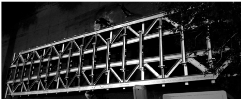
Рис. 3. Установка двух ферм на стенд для испытания и обеспечение устойчивости из плоскости путем установки специальных удерживающих элементов (ЗАО «Ариада», 2018 г.)
