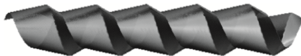
Рис. 3. Труба с винтовой поверхностью теплообмена, образованная движением треугольника в плоскости осевого сечения вдоль винтовой линии, расположенной на круговом цилиндре
