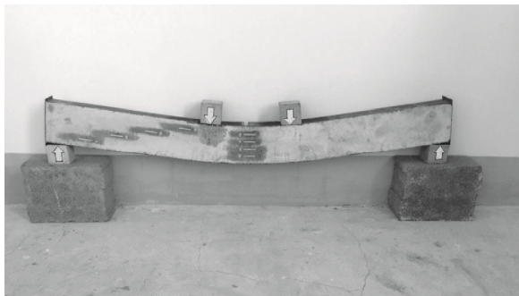
Рис. 9. Балка серии Б1 после испытаний
