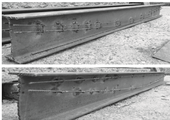
Рис. 5. Общий вид стальных балок до обетонирования Рис. 6. Испытания стандартных кубиков
