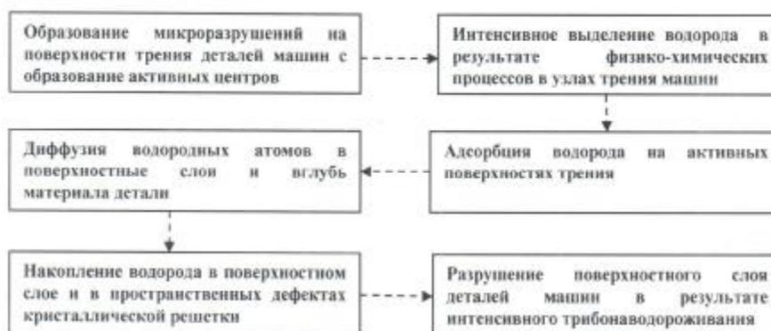
Рис. 2. Основные этапы водородного изнашивания деталей машин
