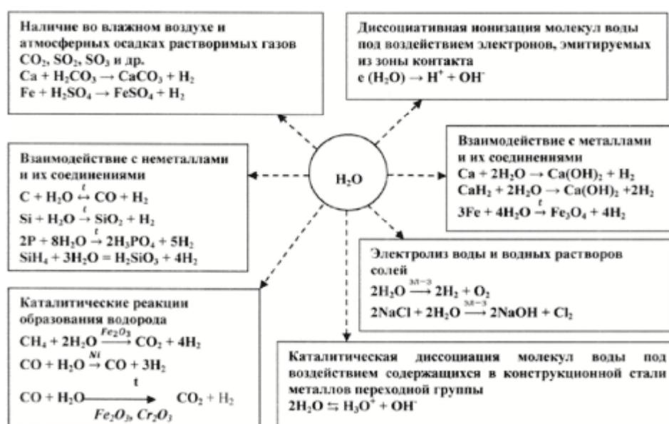
Рис. 1. Физико-химические процессы образования водорода из воды при трибоконтактировании поверхностей деталей
