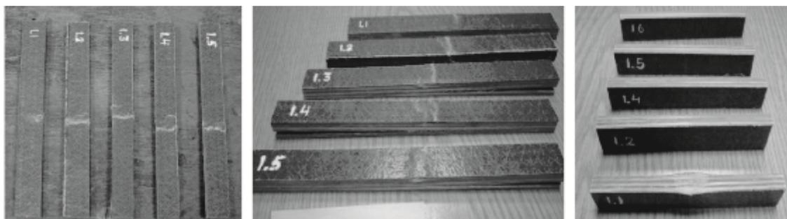
Рис. 3. Образцы пултрузионного стеклопластика с армированием  $0^\circ$  после разрушения при изгибе
