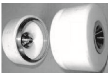
Рис. 2. Внешний вид рабочей камеры гидродинамического кавитатора
