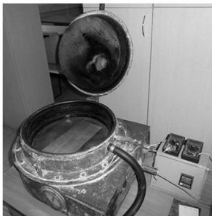
Рис. 1. Экспериментальная установка вакуумно-кондуктивного термомодифицирования древесных материалов
