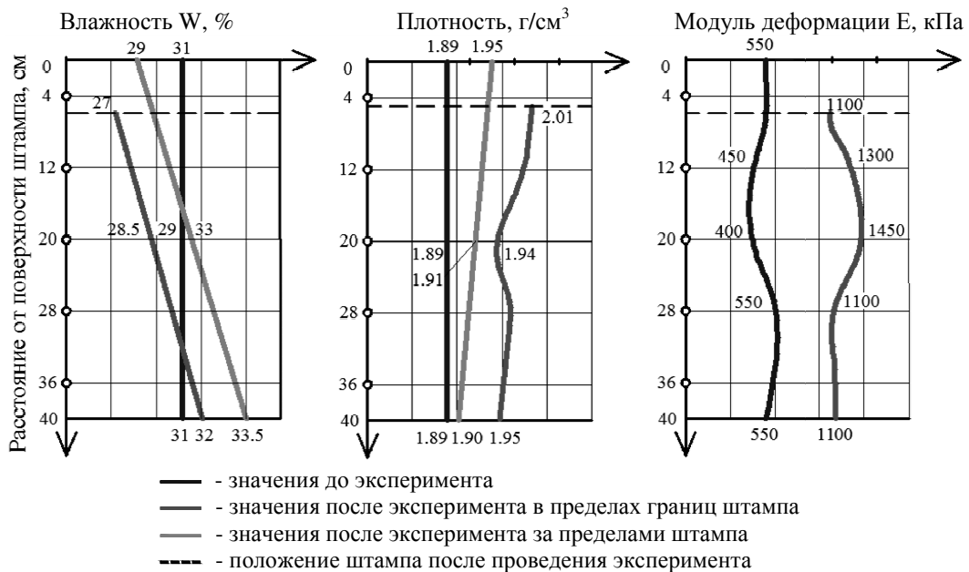
Рис. 3. Обобщенные графики изменения основных физико-механических характеристик грунта
