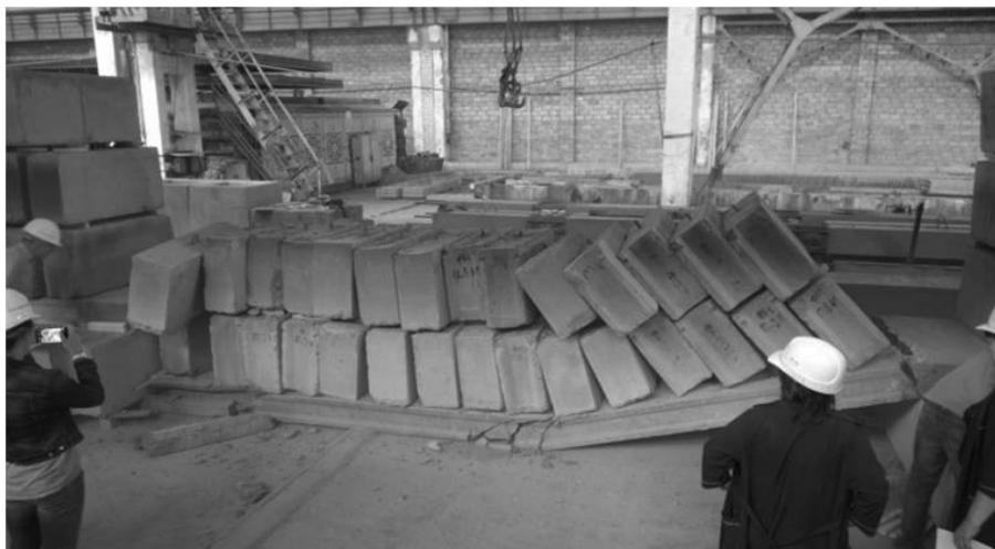
Рис. 6. Разрушение плиты при нагрузке 13720 кг ( $C=2,09$ )
