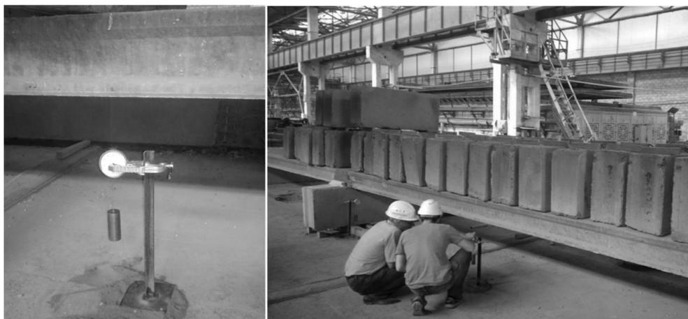
Рис. 4. Измерение прогиба плит прогибомером Аистова БПАО
