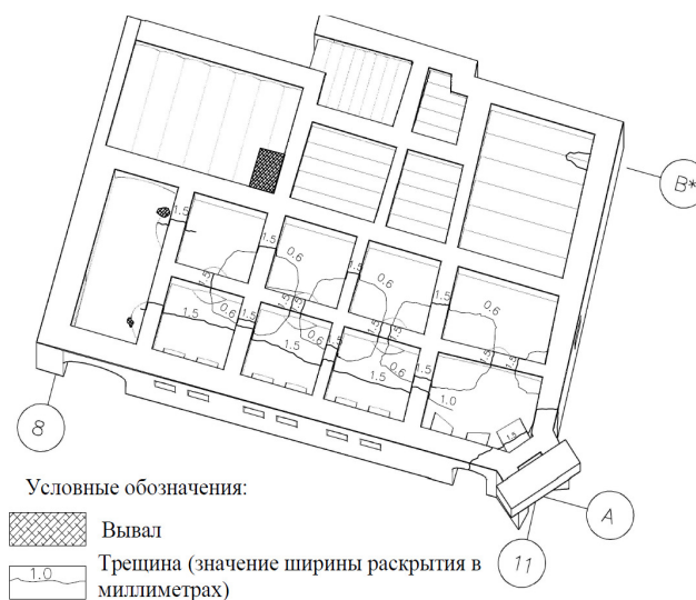
Рис. 2. Дефектная схема перекрытия арочно-стоечной системы
