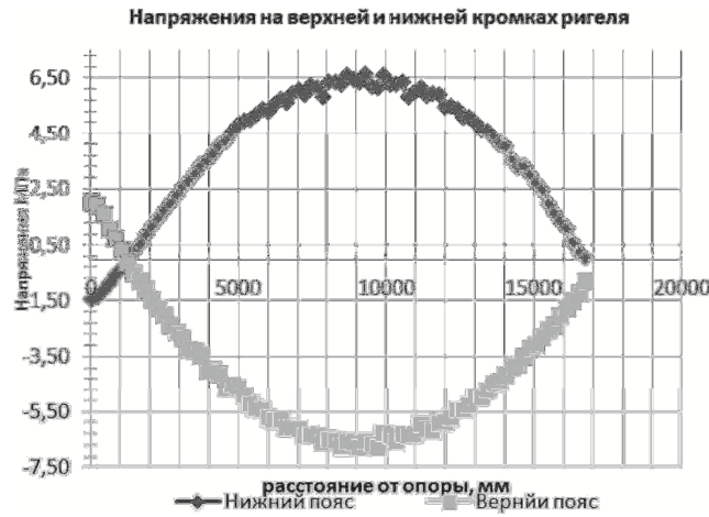
Рис. 3. Распределение нормальных напряжений в верхних фибрах и нижних фибрах ригеля при наличии предварительного натяжения в усиливающем элементе
