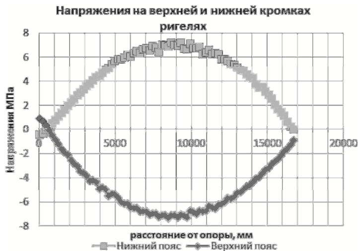
Рис. 2. Распределение нормальных напряжений в верхних фибрах и нижних фибрах ригеля в случае отсутствия предварительного натяжения в усиливающем элементе
