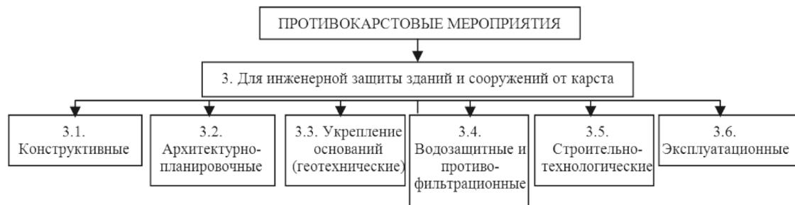
Рис. 2. Классификация противокарстовых мероприятий, ориентированных на инженерную защиту зданий и сооружений
