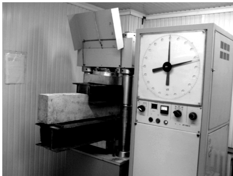
Рис. 6. Испытание железобетонных перемычек марки ЗПБ 16-37 разрушающей нагрузкой
