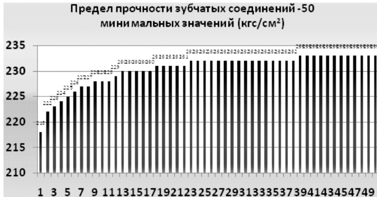
Рис. 18. Минимальные значения предела прочности зубчатых соединений по результатам статистического моделирования
