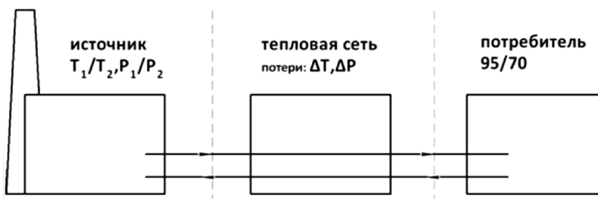
Рис. 2. Схематичная система централизованного теплоснабжения
