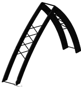
Рис. 9. Конечно-элементная модель 2 арок, соединенных связями
