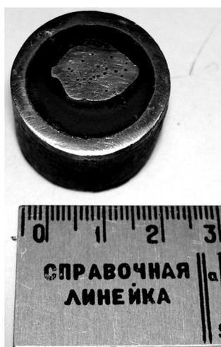
Рис. 1. Образец для измерения твердости в сечении арматуры
