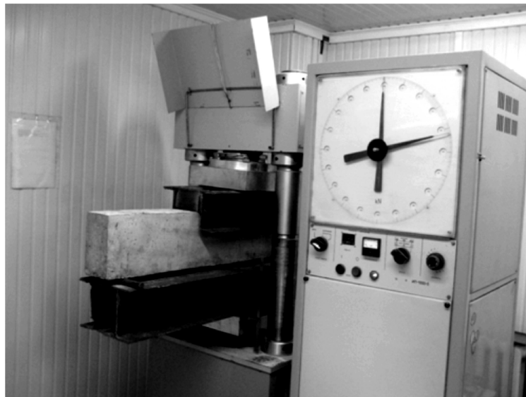
Рис. 6. Испытание железобетонных перемычек марки ЗПБ 16-37 разрушающей нагрузкой
