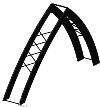
Рис. 9. Конечно-элементная модель 2 арок, соединенных связями
