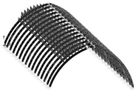
Рис. 12. Конечно-элементная модель склада
