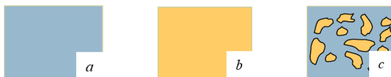
Рис. 1. Характерные этапы поверхности металлических элементов: a – исходная чистая поверхность; b – образование пассивирующего слоя; c – разрушение пассивирующего слоя (иллюстрация авторов)
