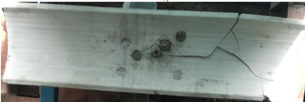
Рис. 7. Сквозные продольные трещины, образующиеся в исследуемой плите-оболочке в стадии предельного равновесия:
