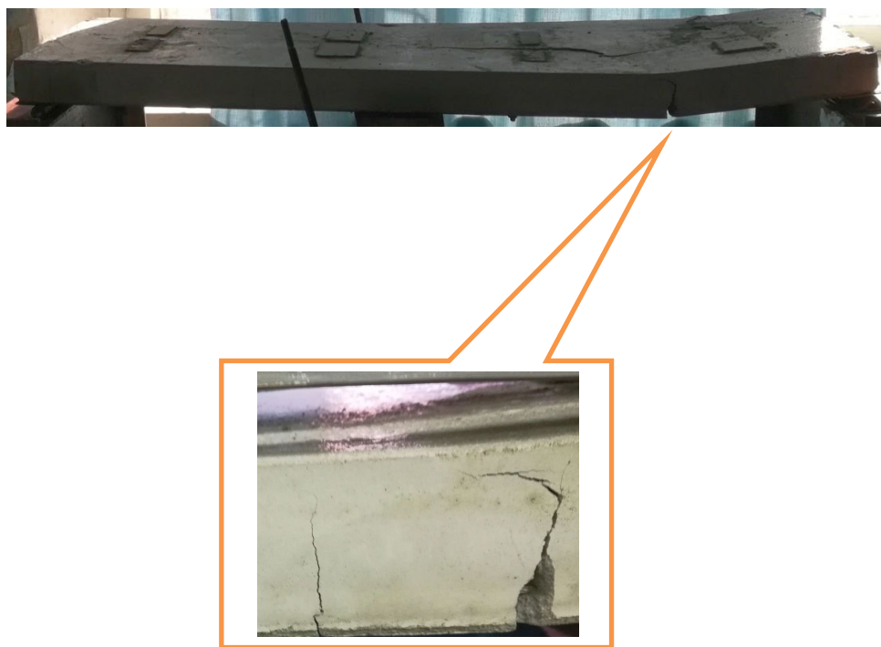
Рис. 6. Магистральная нормальная трещина в продольном контурном ребре (иллюстрация авторов)
