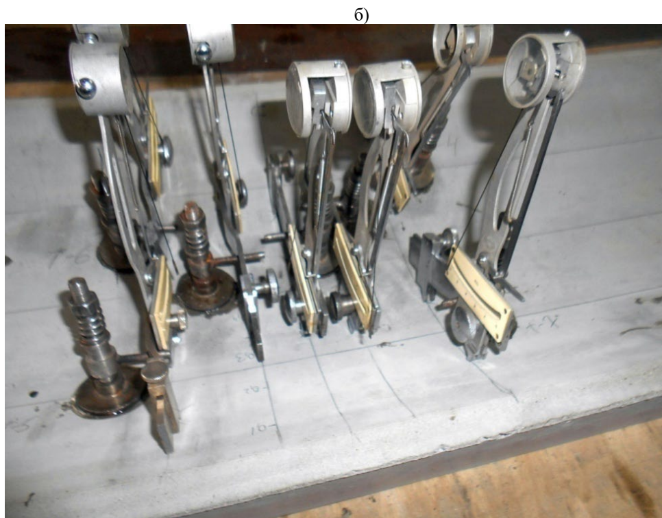
Рис. 4. Крепление рычажных тензометров Т-1 – Т-7 к нижней грани полки модели плиты-оболочки: а). схема, б). фото (иллюстрация авторов)
