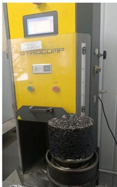
Рис. 1. Изготовление образцов асфальтобетонной смеси на вращательном уплотнителе
