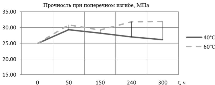
Рис. 5: Влияние термостарения на механические свойства фанеры (иллюстрация авторов)
