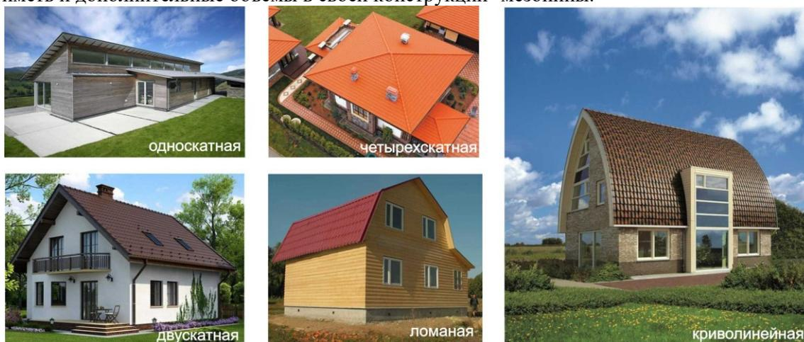
Рис.3 Примеры конструкций скатных крыш
