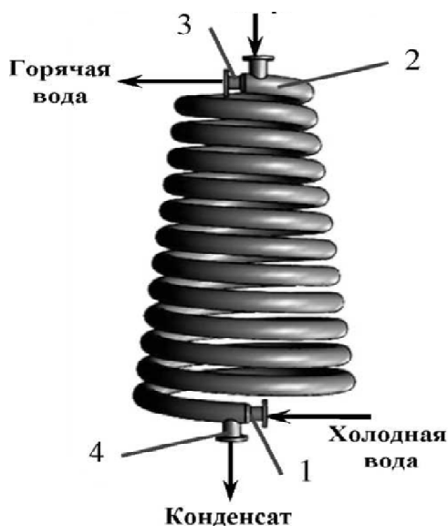
Рис. 1. Конический змеевиковый теплообменник типа «труба в трубе» [12]
