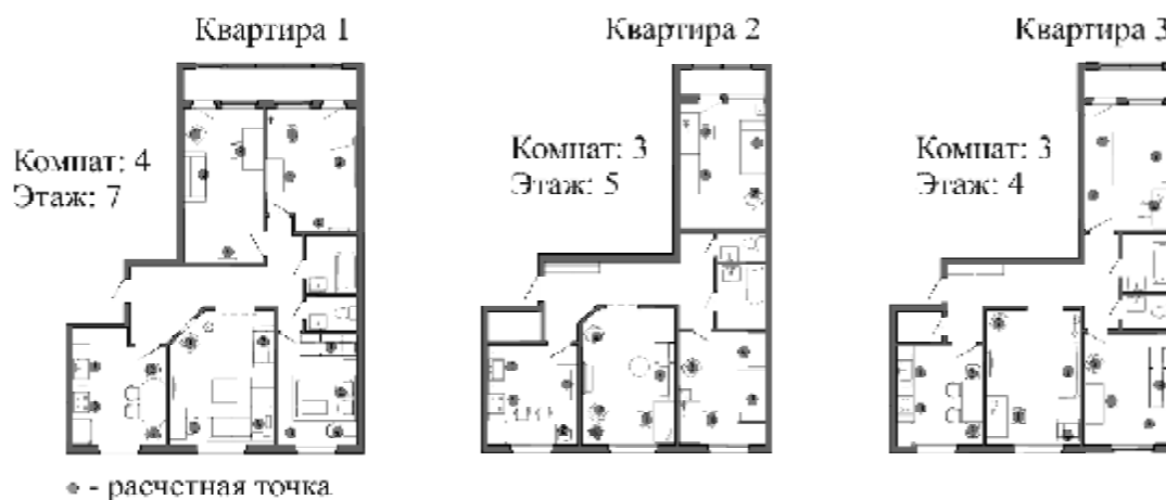
Рис. 2. Планировочные схемы исследуемых квартир с указанием расчетных точек для измерения параметров микроклимата (иллюстрация авторов)
