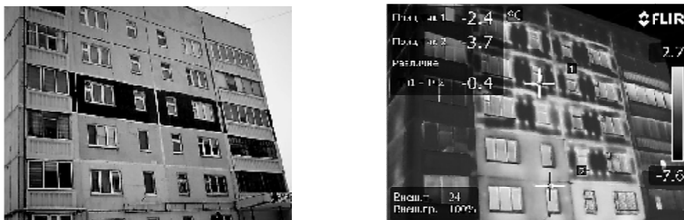
Рис. 3. Термограмма южной стороны здания (иллюстрация авторов)
