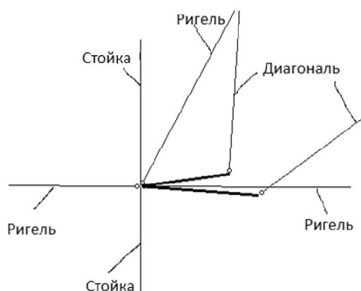
Рис. 2. Типовой узел в расчетной схеме
