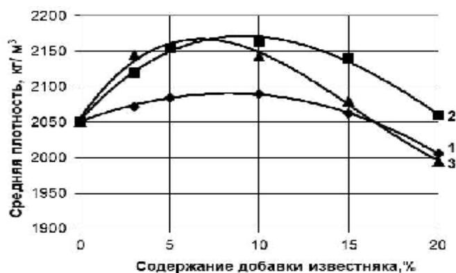
Рис. 4. Влияние содержания молотого известняка на плотность искусственного камня на основе КГВ. Удельная поверхность известняка, м<sup>2</sup>/кг: 1 – 300; 2 – 500; 3 – 800
