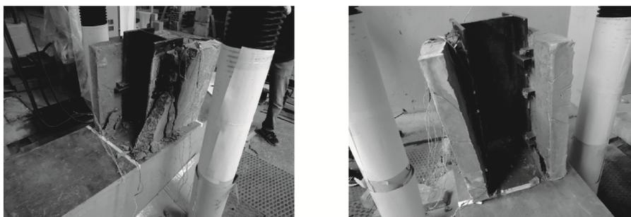
Рис. 5. Сталежелезобетонные призмы после испытаний в прессе ИПС200
