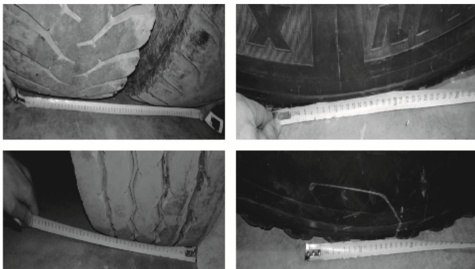
Рис. 3. Измерения пятен контакта колес автомобиля VOLVO FM 400 6×4
