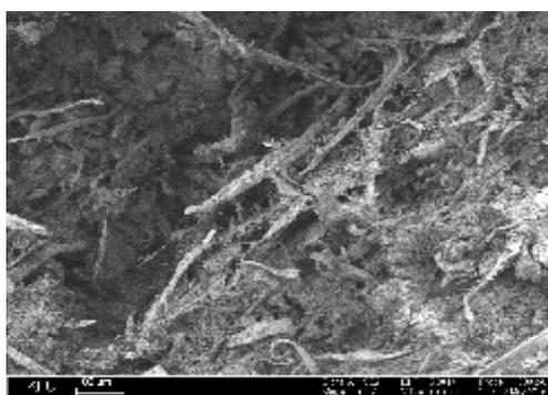
Рис. 2. Электронно-микроскопический снимок ГВЛ при увеличении  $\times 100$
