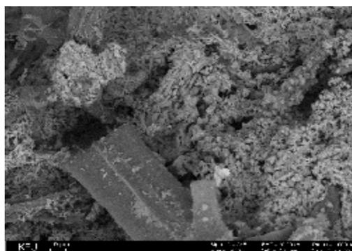
Рис. 3. Электронно-микроскопический снимок ГВЛ при увеличении  $\times 500$
