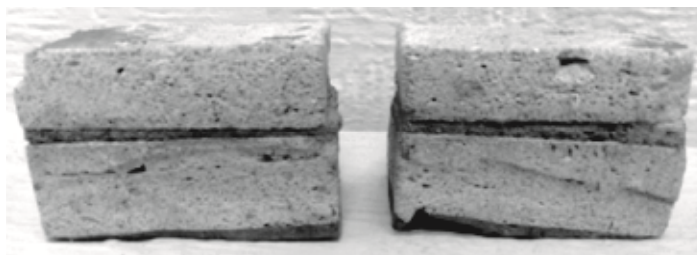
Рис. 7. Склеенные образцы штукатурного раствора
