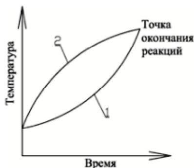
Рис. 1. Характер кривых кинетики процесса минералообразования: 1 – с минерализаторами; 2 – без применения минерализаторов
