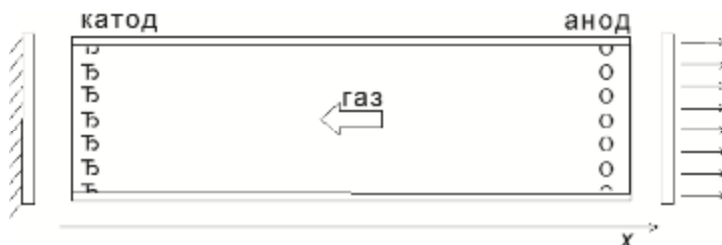
Рис. 1. Схема газоразрядного \text{CO}_2 -лазера с цилиндрической разрядной трубкой
