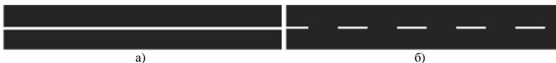
Рис. 3. Горизонтальная разметка 1.1 (а) и 1.5 (б)
