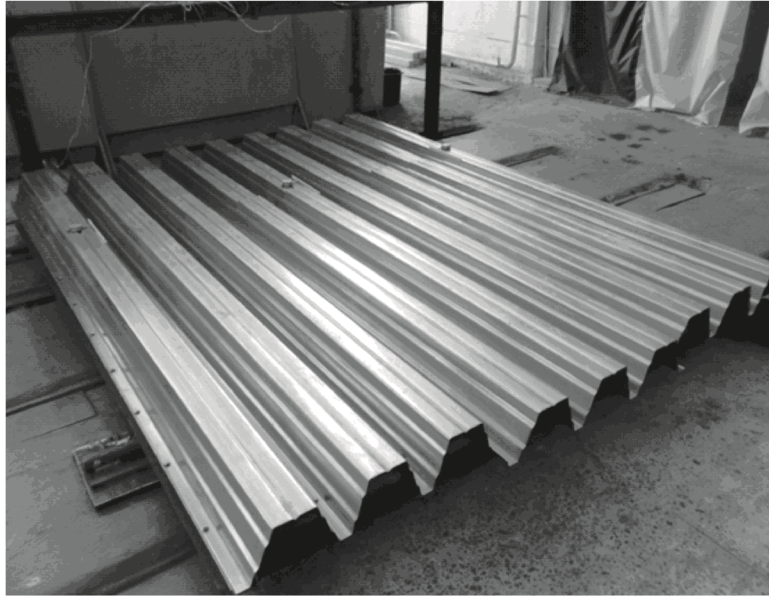
Рис. 3. Общий вид экспериментальной установки с профилированным настилом
