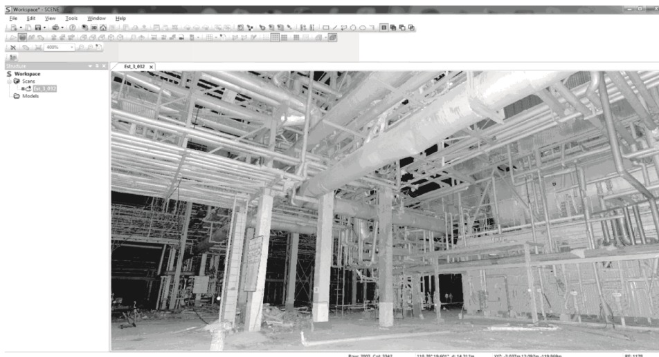
Рис. 2. Фрагмент эстакады в программе Scene 5.1, наложение фото на облако точек
