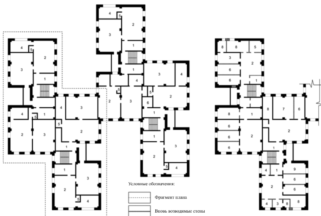
Рис. 2. Варианты перепланировки групповых ячеек типового проекта 212-2-63 яслей-сада на 320 мест: А – исходный план: 1 – раздевальная, 2 – игральная-столовая, 3 – спальня, 4 – туалетная, 5 – буфетная, 6 – бельевая; Б – примеры перепланировки групповых ячеек под жилые квартиры воспитанников вместимостью 8-12 человек: 1 – холл (гардеробная), 2 – общая комната, 3 – комната воспитателя, 4 – комната на 1 человека, 5 – комната на 1-2 человека, 6 – комната на 3-4 человека, 7 – комната на 4-5 человек, 8 – с/у с душевой, 9 – комната для занятий с психологом
