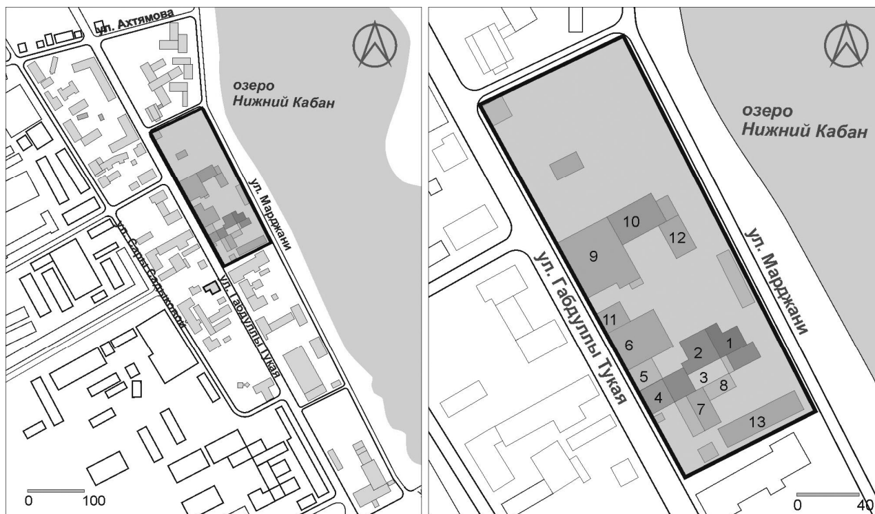
Рис. 1. Ситуационный план территории, подлежащей реконструкции, и строения на нем: 1-корпус солодовни, 2-корпус солодосушильни, 3-корпус для производства сусла, 4-корпус для охлаждения сусла, 5-корпус производственный, 6-корпус бродильного отделения, 7-корпус производственный, 8-корпус кузницы, 9-корпус подвала, 10-корпус ледника, 11-жилой дом для рабочих, 12-жилой дом для рабочих, 13-корпус производственный.
