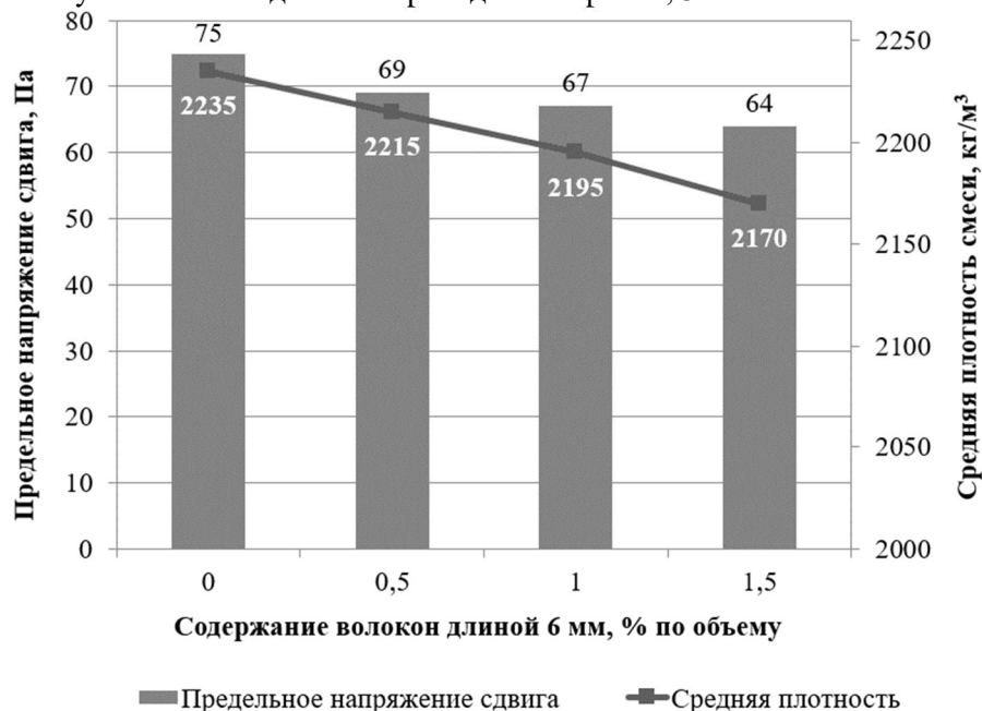
Рис. 2. Влияние содержания стальных волокон длиной 6 мм на среднюю плотность и предельное напряжение сдвига смеси (иллюстрация авторов)
