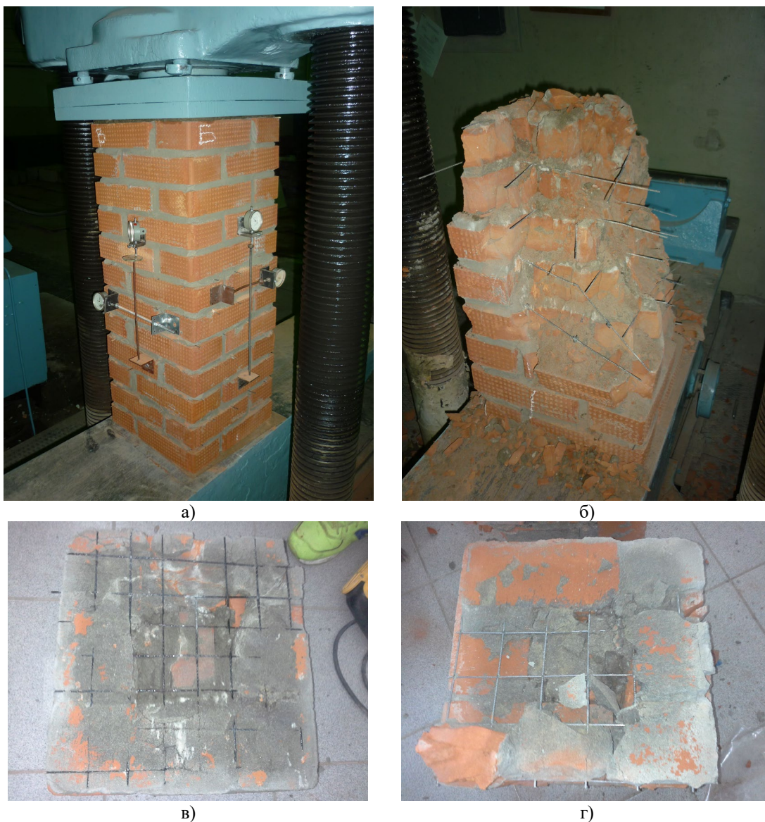
Рис. 7. Опытные образцы с кладочными стальными и полимеркомпозитными сетками а) подготовленный к испытанию образец; б) фрагмент разрушенного образца; в, г) поперечные сечения образцов, армированных композитными и стальными сетками (иллюстрация авторов)
