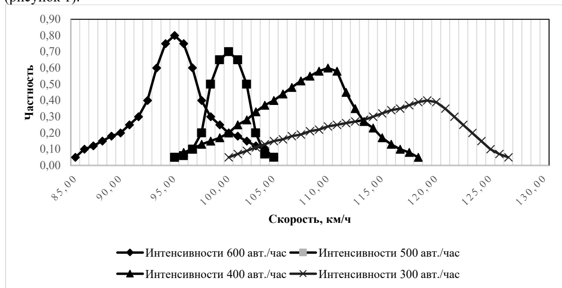
Рис. 1. Характер изменения скорости движения в зависимости от интенсивности потока: кривая 1 соответствует интенсивности 600 авт./час, кривая 2 – 500 авт./час, кривая 3 – 400 авт./час, кривая 4 – 300 авт./час (иллюстрация автора)
